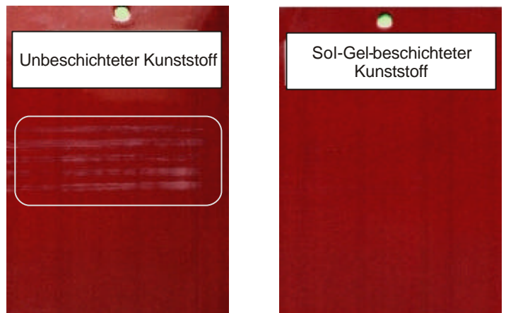
1a: starke Kratzspuren
