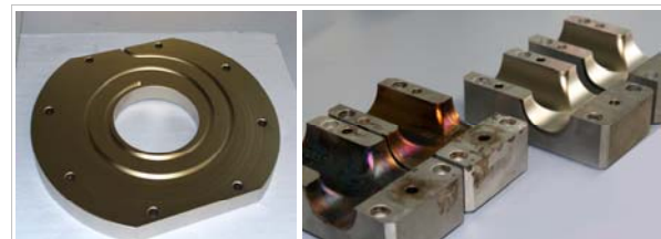
links: beheizbarer Ziehring, rechts: T-IHU-Gesenke
