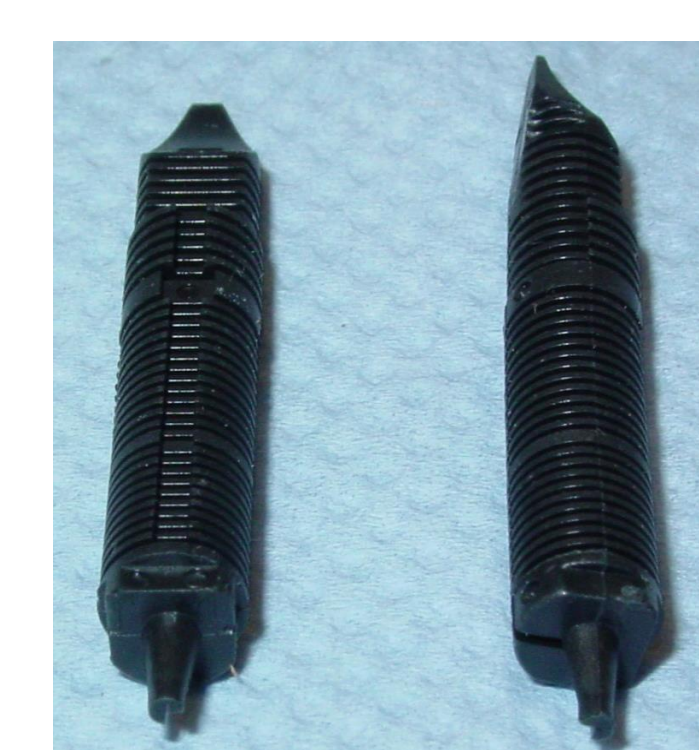
Reinigung von Realbauteilen: Tintenleiter aus ABS (links) – Zunehmende Benetzung durch Füllhaltertinte in plasmabehandelten Tintenleitern (rechts)
