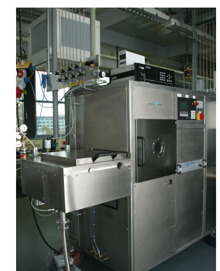
Niederdruck-Plasmareaktoren (13.56 MHz bzw. 2.45 GHz) an beiden Forschungsstellen
