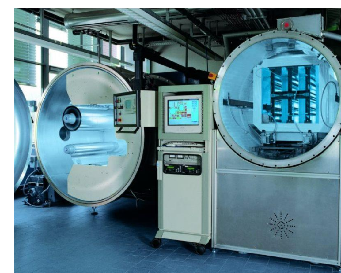
Niederdruck-Plasmareaktoren (13.56 MHz bzw. 2.45 GHz) an beiden Forschungsstellen
