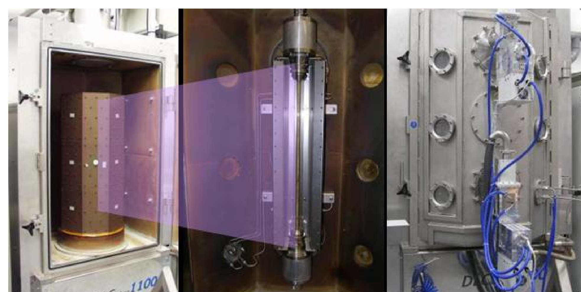
Lineare Plasmaquelle, installiert in einer PECVD-Anlage, mit dem Standard-Substrathalter für die Beschichtung von kleineren Bauteilen
