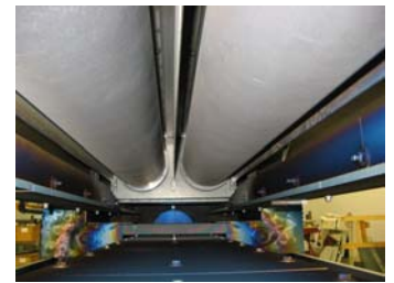
Magnetron-Plasma CVD – reaktives Sputtern mittels Doppelrohr-Kathode
