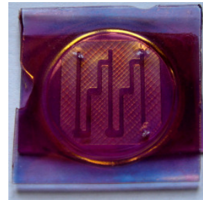
Mikrofluidik-Chip mit Kanalstruktur und Zugangsbohrungen
