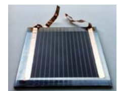
CIGSe-Minimodul 10 x 10 cm 2 , laserstrukturiert
