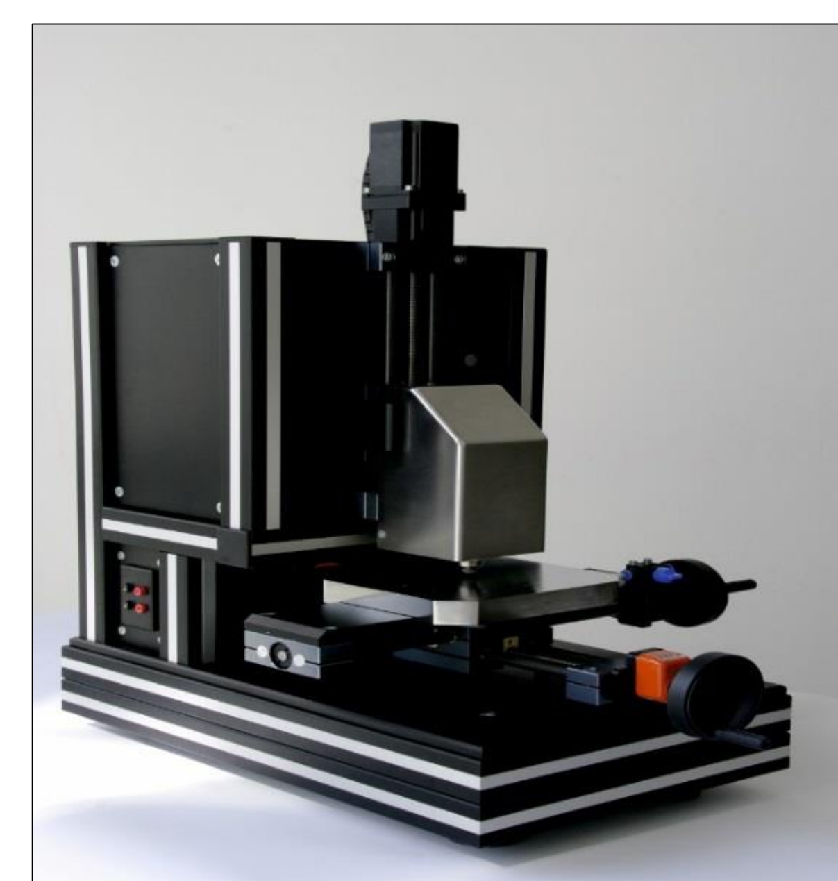
Messgerät E-CON mit Kontaktierungssonde, bestehend aus magnetischen und Silber-beschichteten Partikeln.
