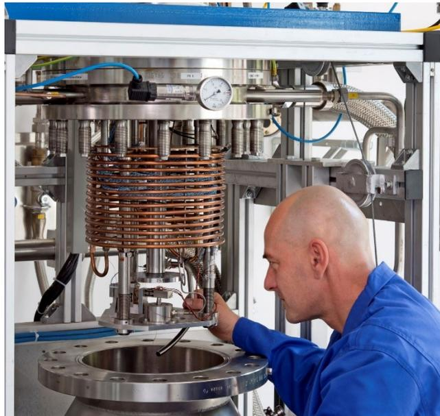
Probenwechsel in einem Tribometer für
